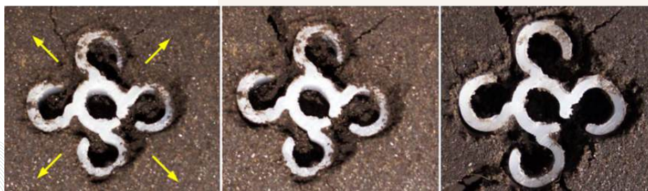
Rysunek 5 – Otwieranie łopatek urządzenia GEPS, gdy gleba jest sucha.
